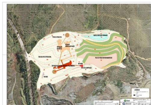
**Figuras 01 e 02.** Vista das instalações do empreendimento antes e depois da alteração respectivamente, que consistiu na retirada das duas pilhas ao norte (cor verde) e reorientação da planta de beneficiamento. Fonte: Geomil.
