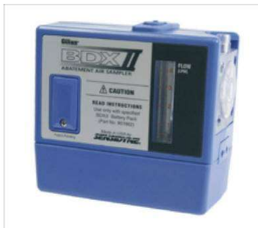
Figura 47 - Equipamento utilizado para amostragem de poeira -Gilian Sensidyne BDX II.
