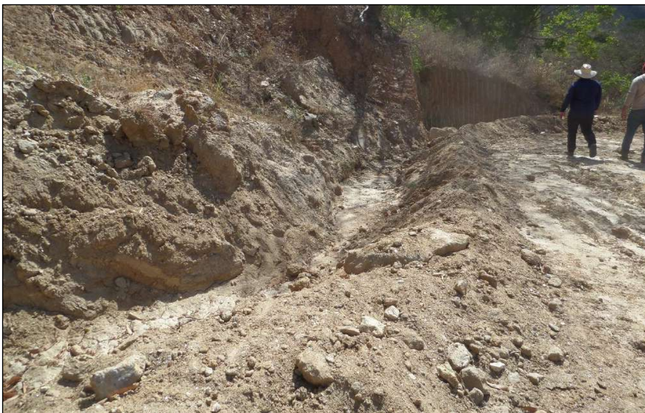
Figura 10 – Canaletas direcionando o escoamento para caixa seca presente na área da frente de lavra denominada Olympus.
