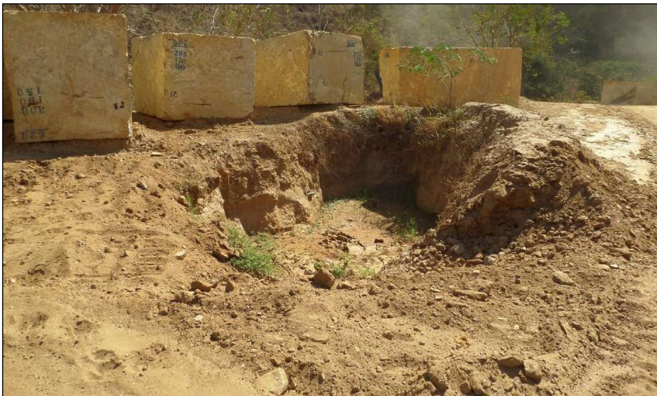
Figura 4 – Bacia de sedimentação localizada na frente de lavra.
