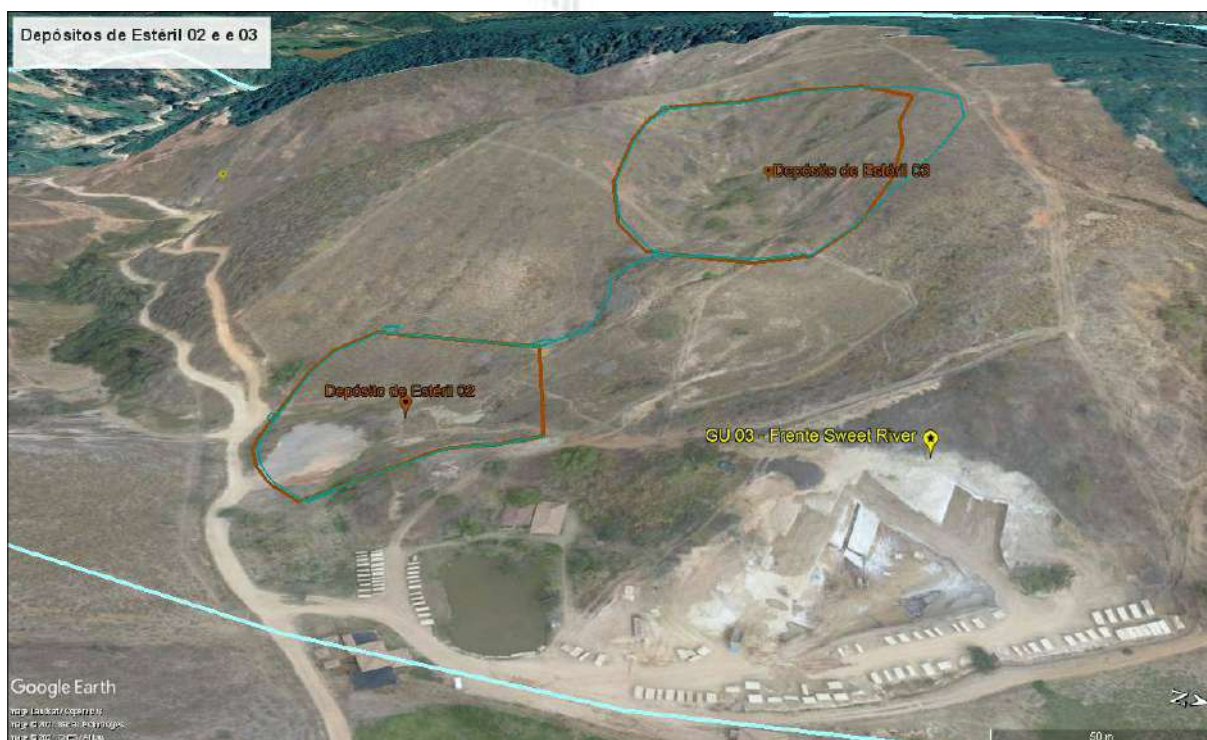
Figura 38 - Imagem inclinada denotando os limites previstos para os Depósitos de Estéril 02 e 03 projetados e seu sistema de drenagem interconectado. Fonte: Mosaico do levantamento aerofotográfico projetado no Google Earth Pro®.
