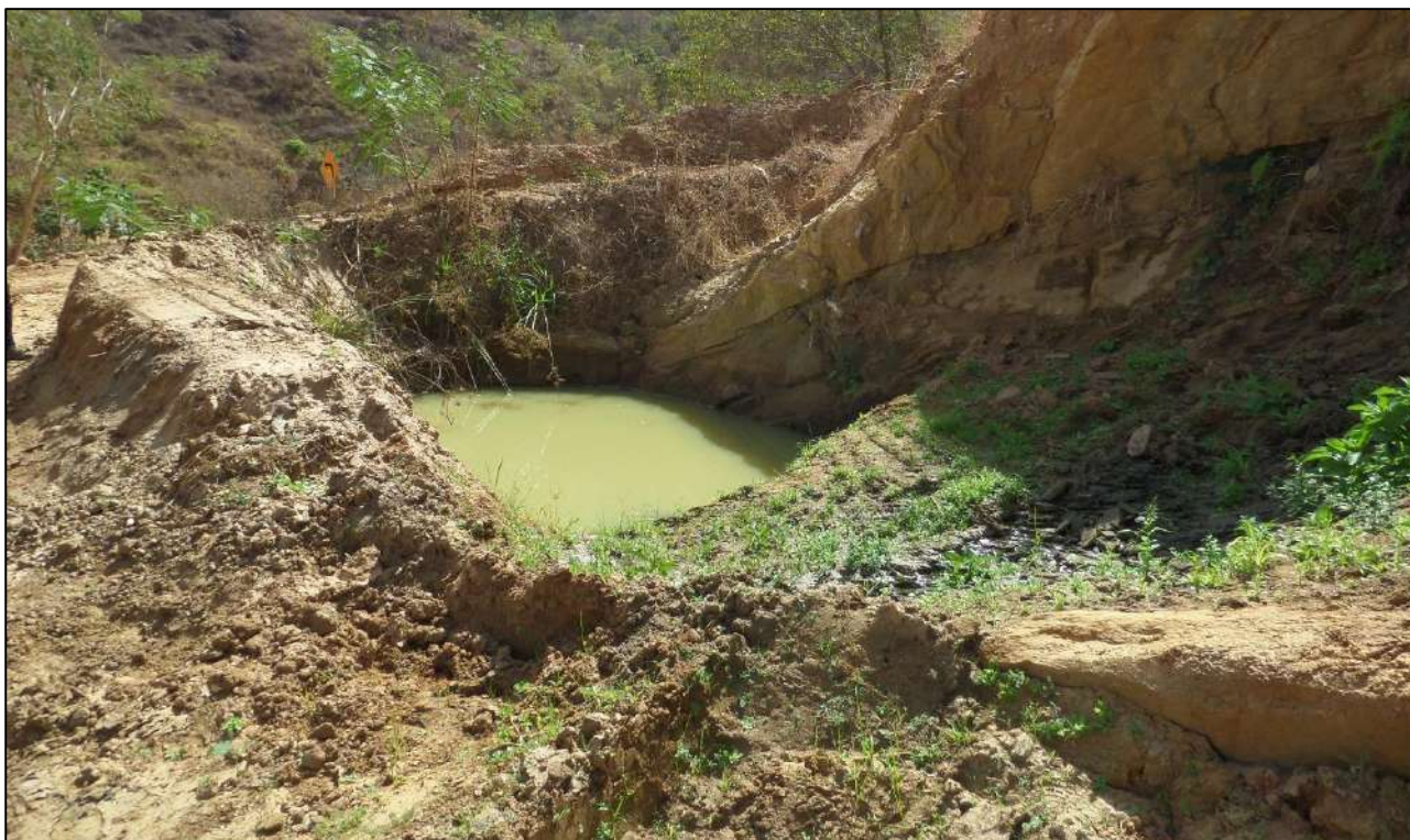
Figura 5 – Caixa seca que recebe todo o escoamento da parte superior à frente de lavra.
