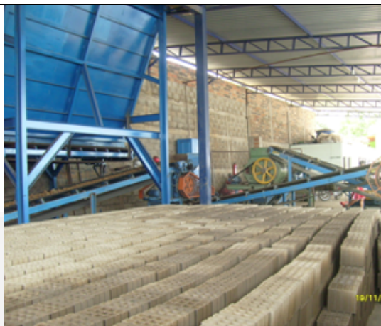
Foto 04. Rosca dosadora e correias rolantes do processo de produção.
