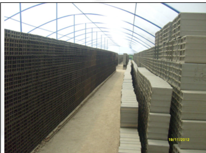
Foto 05. Estufa para secagem natural dos tijolos
