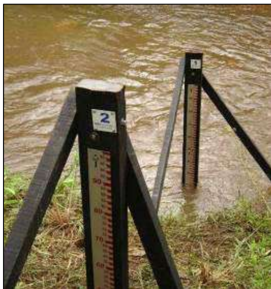
Figura 20: Régua Limnimétrica - RMW-01 (foz do córrego Samambaia) Fonte: EIA Mineração Usiminas, 2018
