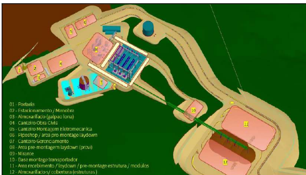
Figura 9: Layout da Planta de Filtragem com Canteiro de Obras
