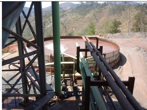
Fotografia 18: UTM implantada. Detalhes para o tanque de água recirculada. Vistoria 26/08/2015.
