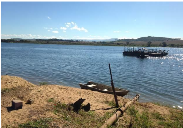
Foto 01. Vista da draga estacionária localizada na Usina Hidroelétrica Marechal Mascarenhas de Moraes / Rio Grande e tubulação para direcionamento da polpa até o pátio de deságue/estocagem.
