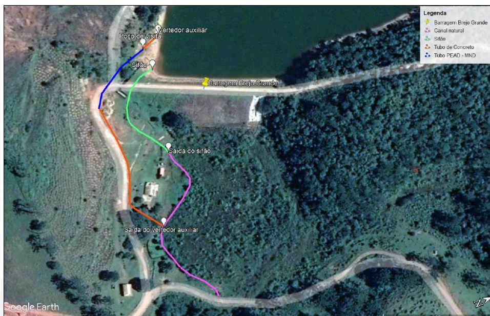
Figura 10 – Croqui esquemático do vertedor auxiliar. Fonte: RISE-2023.
