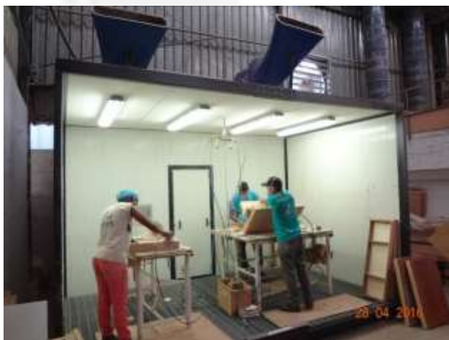
Existem 3 cabines de lixação com sistema de exaustão implantado no chão
