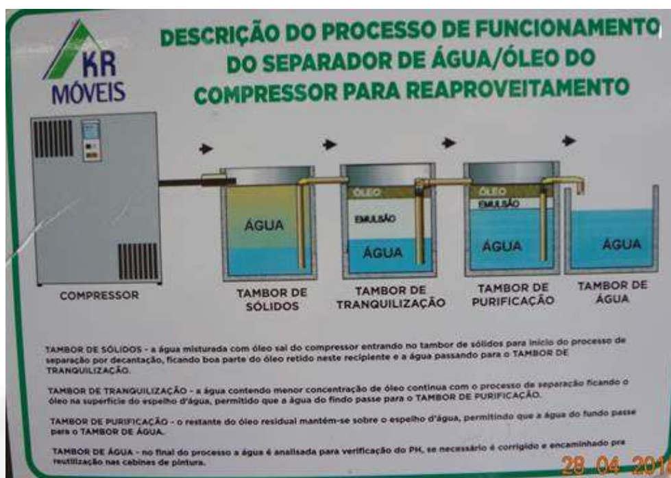
Processo de tratamento da purga do compressor
