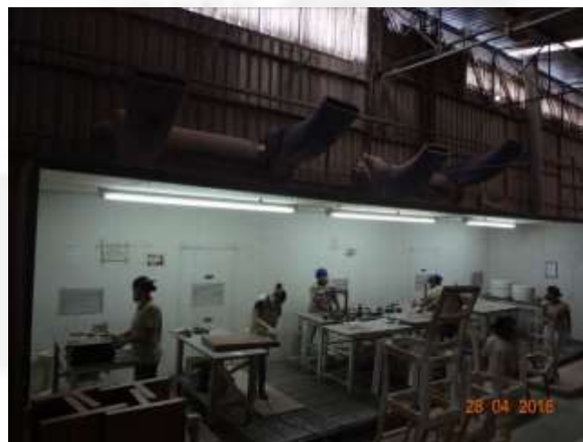
Existem 3 cabines de lixação com sistema de exaustão implantado no chão
