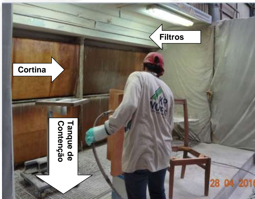
Sistema de mitigação na cabine de pintura – Cortina d’água, tanque de contenção dos sólidos, filtros.
