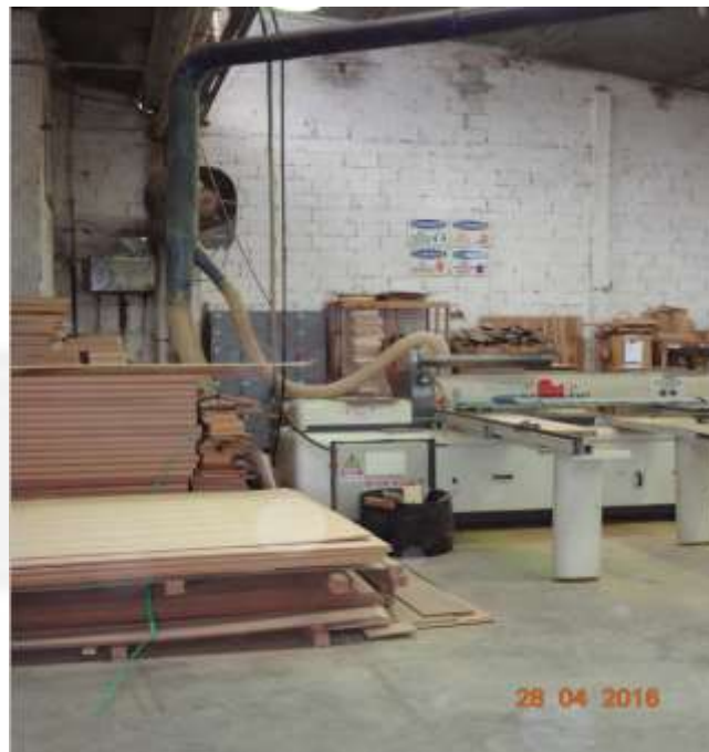
Sistema de tubulação distribuída em toda fábrica e interligadas aos maquinários afins
