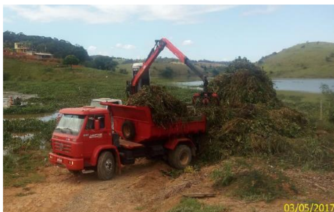
Figura 12: Caminhão com grua adaptada fazendo a retirada de macrófitas.
