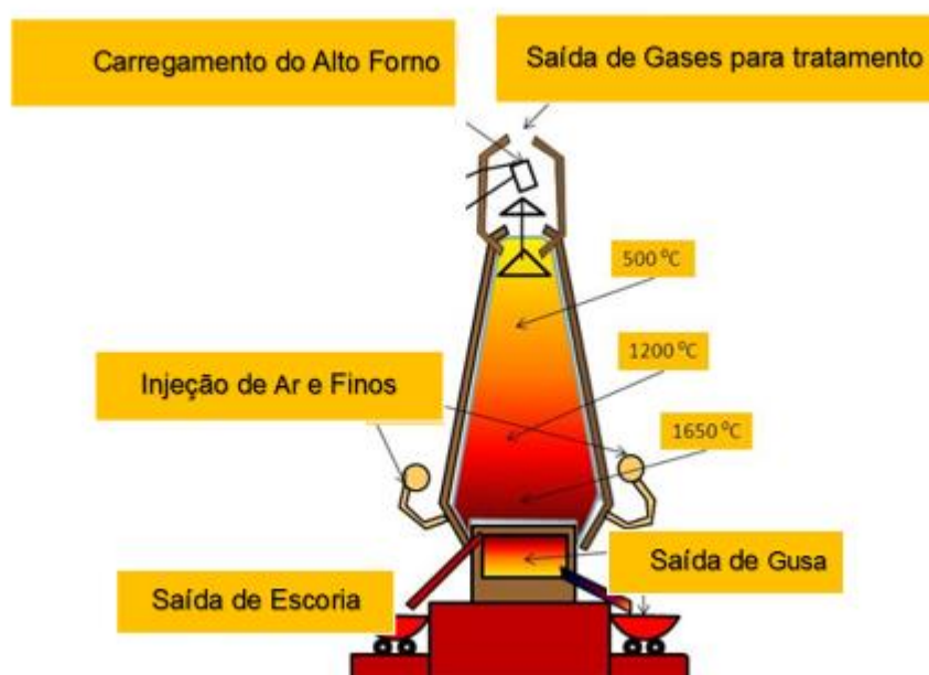
Fig. 2 – Desenho esquemático da produção de ferro gusa (fonte RADA).
