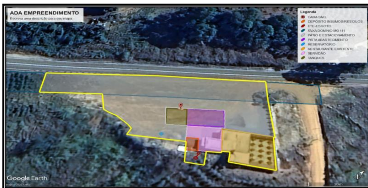
Figura 2: Imagem de satélite apresentando a ADA do empreendimento destacando a localização da pista de abastecimento, área dos tanques de armazenamento de combustíveis, servidão, depósito, pista de manobra e estacionamento, locais dos sistemas de controle ambientais e reservatório. Fonte: RAS.
