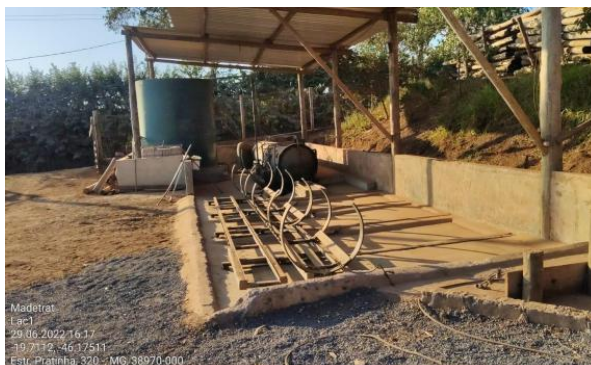
Foto 01. Vista do autoclave onde é realizado o tratamento da madeira. Fonte: Relatório fotográfico.
