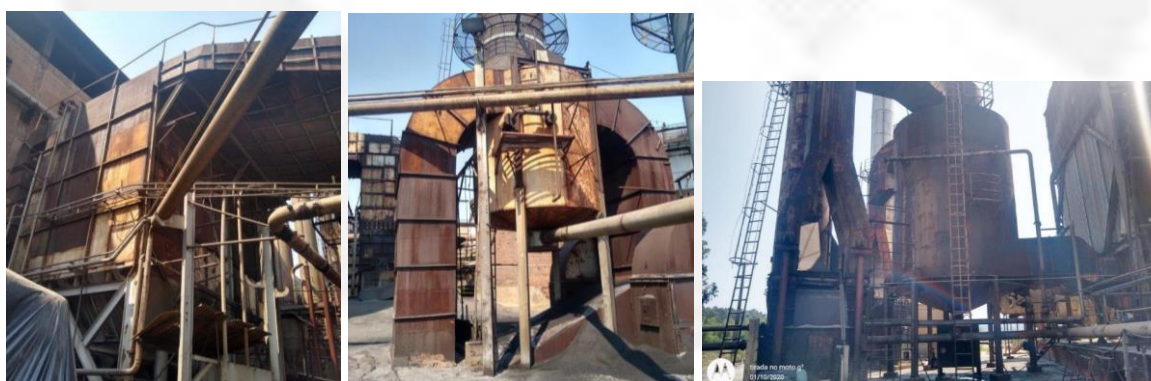
Imagem: Lavadores de gases das caldeiras em operação
