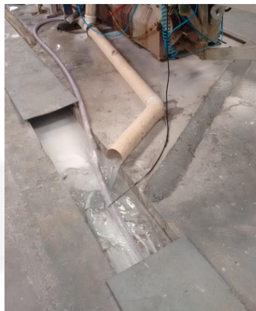
Foto 06. Efluente da lapidação contendo pó de vidro
