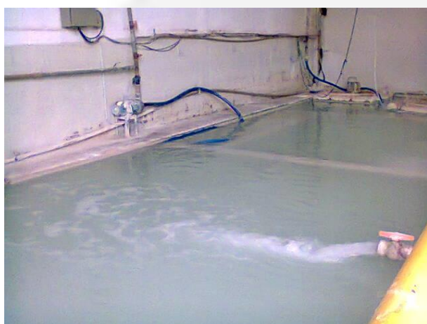
Foto 01. Sistema de decantação do pó de vidro
