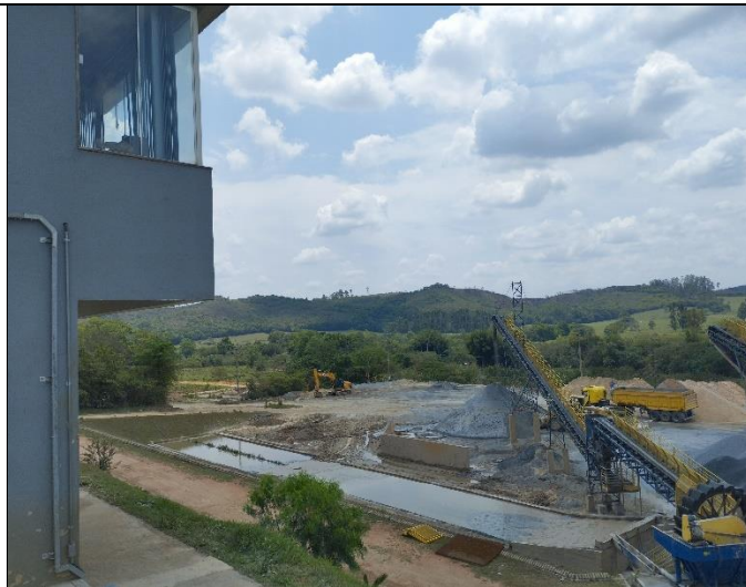
Foto 2: Areia obtida via úmido com 02 deslamadores de argila. Bacias de decantação da lama gerada nos deslamadores
