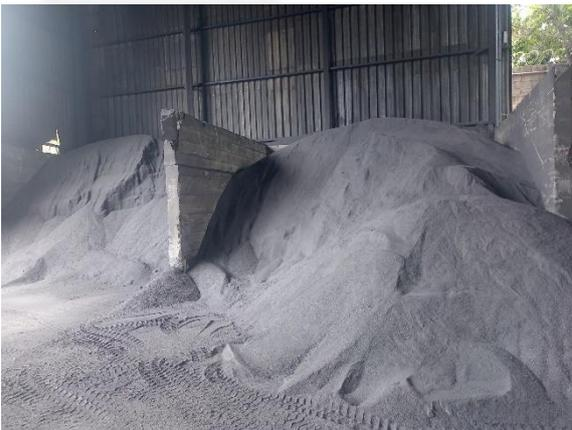
Foto 3: Escória de silício em pó utilizada no processo de briquetagem.
