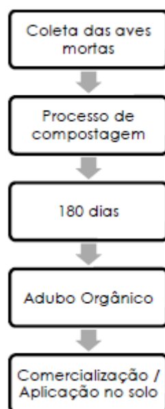
Figura 07. Detalhamento da compostagem das aves mortas. Fonte: RCA.
