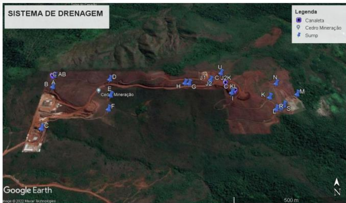
Figura 7.1.2: Disposição do sistema de drenagem ao longo da mina. Fonte: Documento SEI 52292278.
