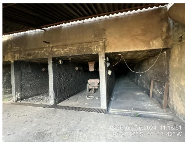
Foto 10: Parte inferior ao galpão de carvão, onde o operador manualmente carrega o carvão para inseri-lo no sistema do alto-forno
