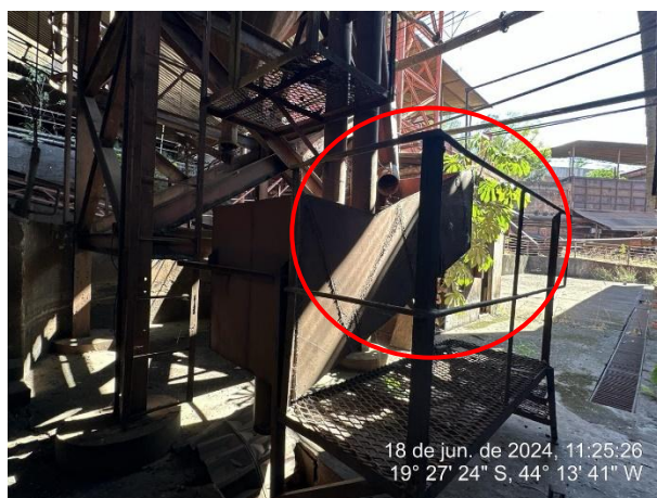
Foto 66: Parte do sistema que direciona lama do lavador de gases
