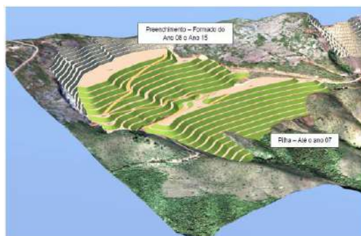
Figura 68: Imagem de seção típica de codisposição de estéril/rejeito e projeção tridimensional em área de cava com jazida.
