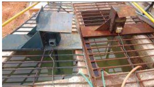
Figura 8: Dosador de produtos químicos para decantação.
