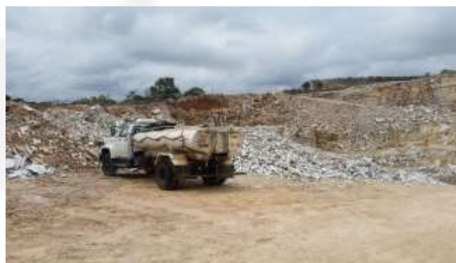
Foto 04. Visão geral da frente de lavra e do caminhão pipa utilizado para umidificar as vias.
