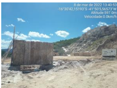
Figura 19. Frente de lavra, bloco sendo cortado com fio diamantado
