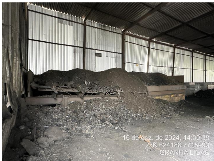
Foto 8: Ponto de alimentação dos fornos (com minérios, carvão vegetal e coque).
