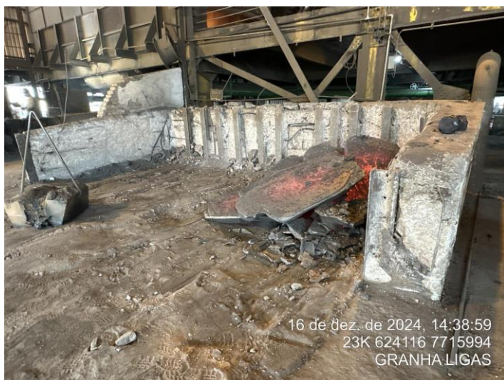
Foto 17: Lingotes sendo resfriados naturalmente.
