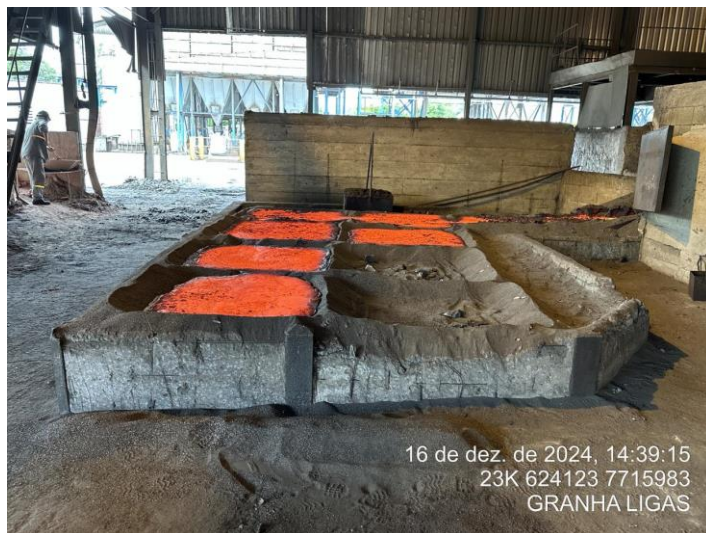
Foto 16: Lingotes das ligas sendo produzidos.
