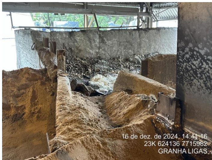
Foto 10: Ala de corrida onde ocorre o escoamento da liga e escória.
