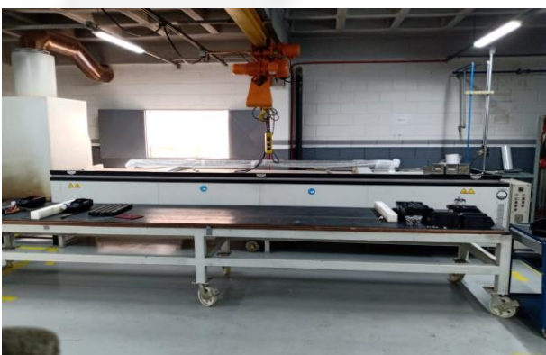
Foto 3: Área de limpeza de fieiras com forno de pirólise (fundo à esquerda)
