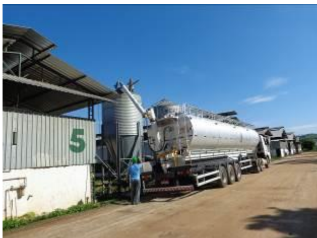
Foto 05. Abastecimento dos silos de ração dos galpões
