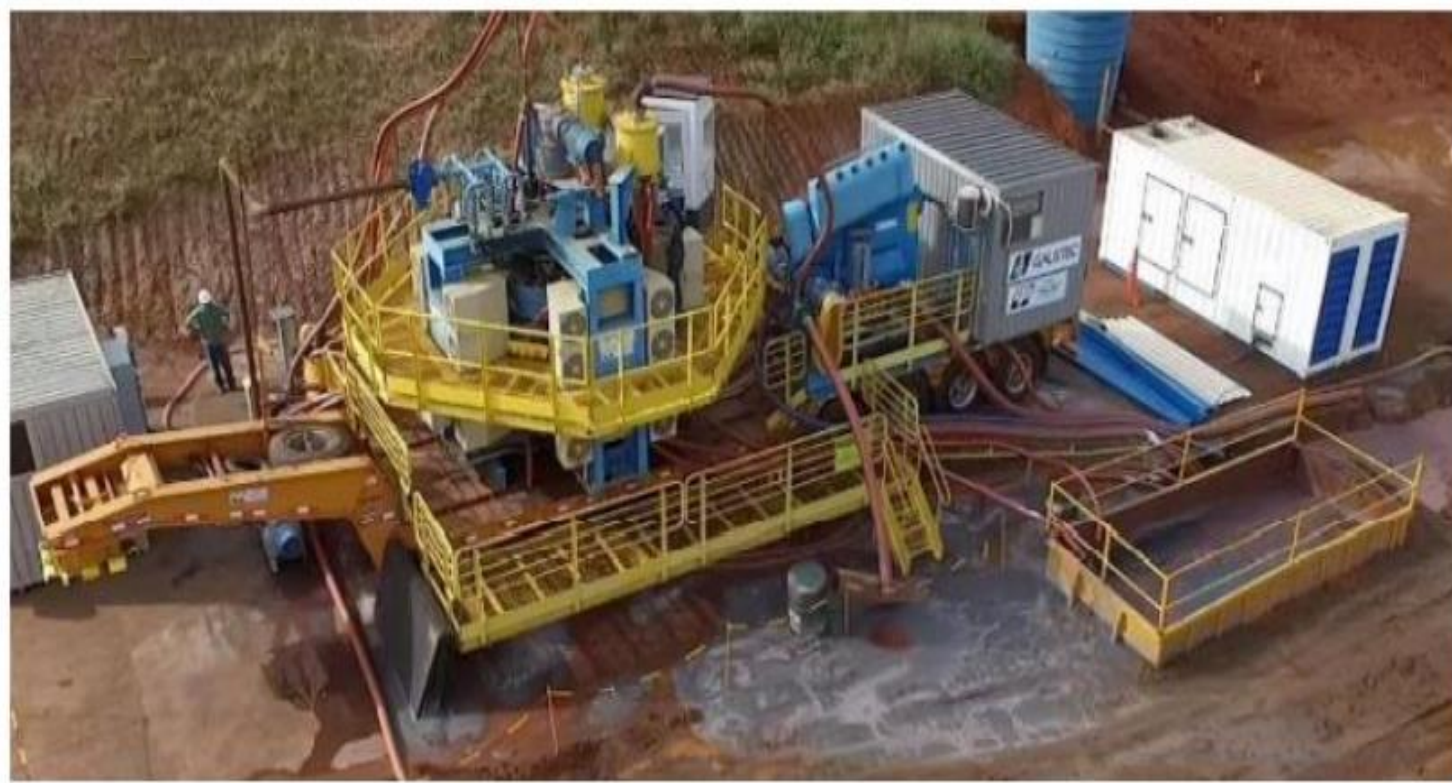
Figura 03 – Vista da unidade de concentração móvel que complementa juntamente com o peneiramento e desaguadores a UTM já existente para a recuperação da sílica.
