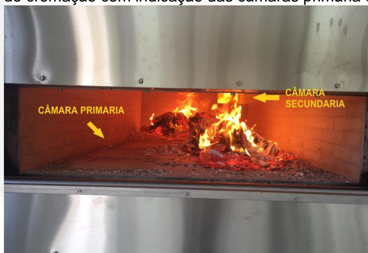
Figura 3 – Forno de cremação com indicação das câmaras primária e secundária.
