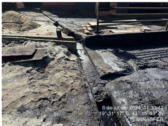
Foto 43: Efluente do lavador de gás sendo direcionado nas canaletas
