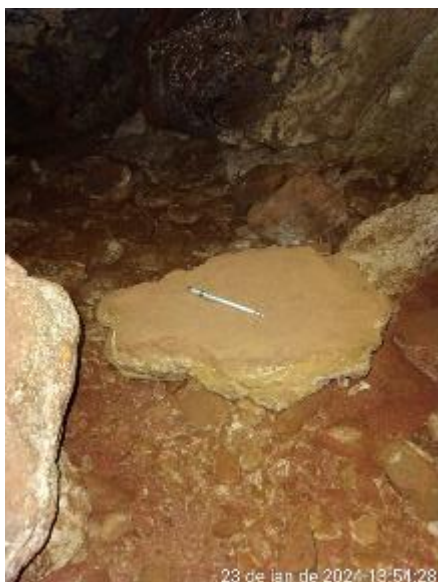
Foto 71 – Bloco desagregado do teto indicando sinais oxidativos.
