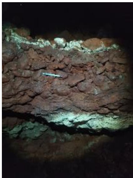
Foto 50 – Ponto de desagregação dos clastos na parede.
