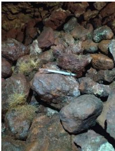
Foto 49 – Rochas com oxidação evidente e colonização por raízes em pontos úmidos.
