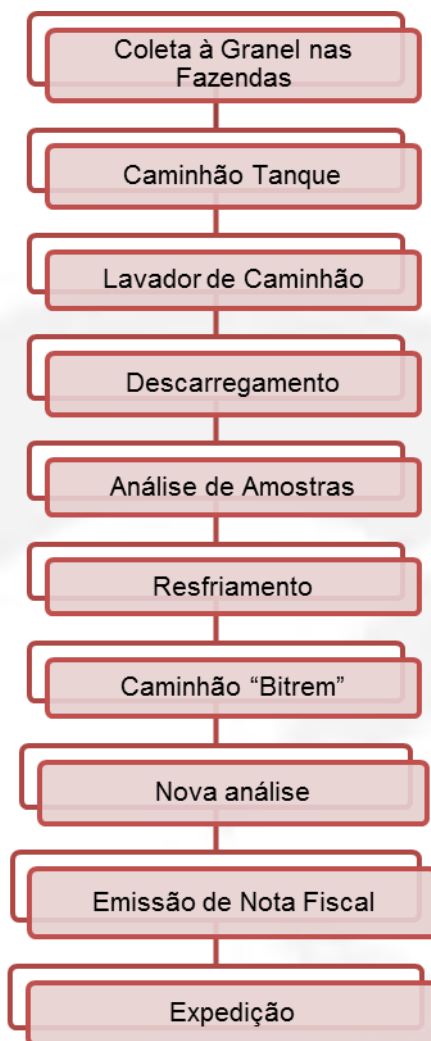
FIGURA 01 - Fluxograma resumido do processo produtivo da VIGOR ALIMENTOS S/A.
