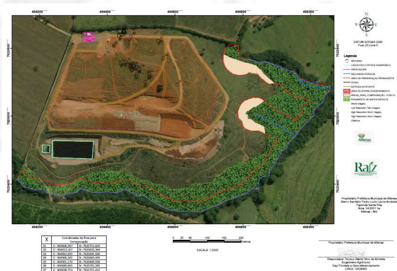
Figura 17 – Árvores isoladas existentes na área do aterro a serem suprimidas na implantação das novas etapas e área para compensação ambiental (Fonte: Processo 01027/2017).
