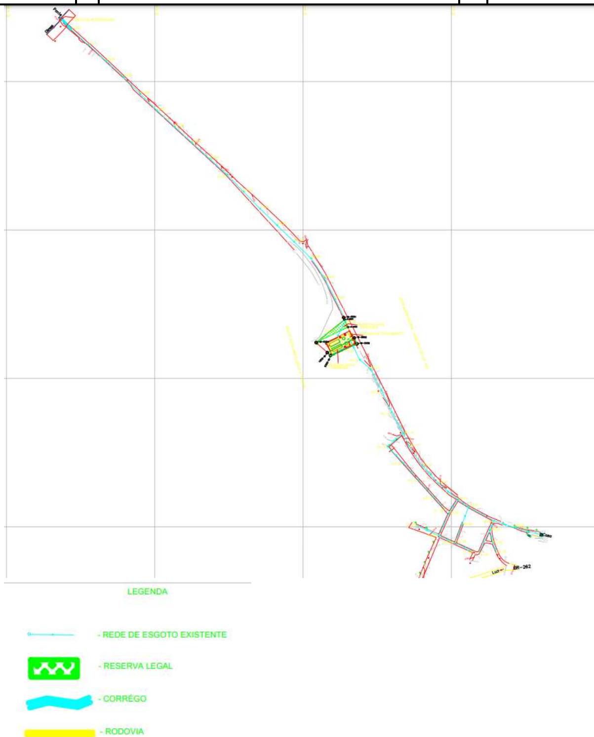
Figura 2. Planta do sistema de esgotamento sanitário e tratamento de esgotos da comunidade do Campinho, em Luz/MG.
