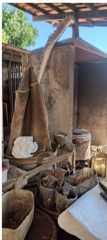
Figura 06: Forno de fundição usado e equipamento denominado filtro manga. Fonte: Vistoria – 16/07/2021.
