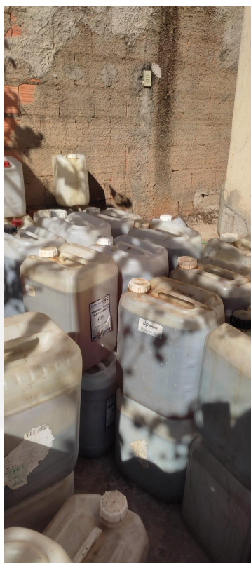
Figura 05: Embalagens contendo líquido usado em fixadores gráficos, radiológicos e branqueadores de fotografia dispostas em local sem cobertura e contenção. Fonte: Vistoria – 16/07/2021.
