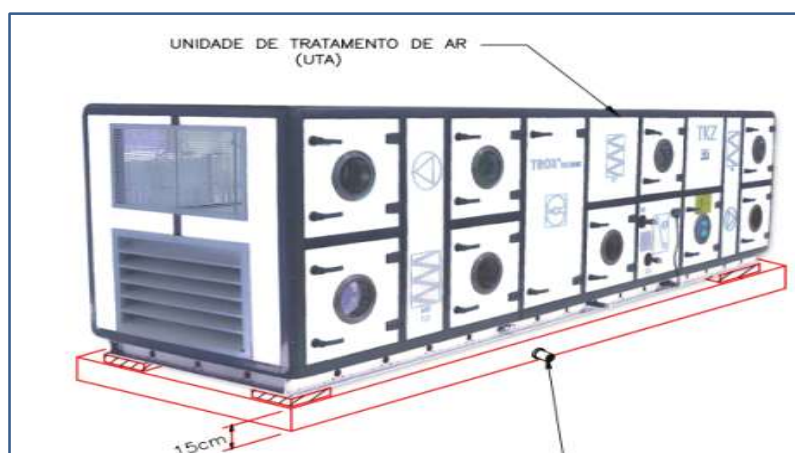
Figura 24 - Unidade de Tratamento de Ar.
