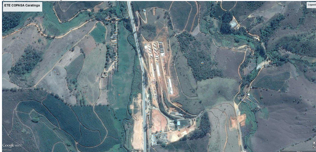
Figura 1: Visão da ETE COPASA Caratinga, durante a fase de instalação mostrando as três unidades funcionais (reatores, filtros biológicos e decantadores) situadas em forma escalonada e sobrepostas
