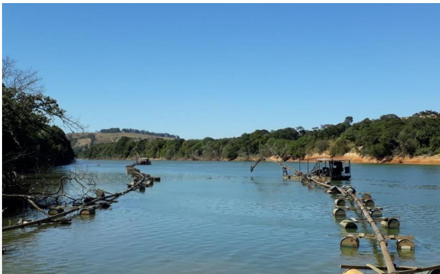
Figura 04: Dragas utilizada no processo de extração de areia no leito do Rio Grande nos limites dos direitos minerários. Fonte: PCA.
