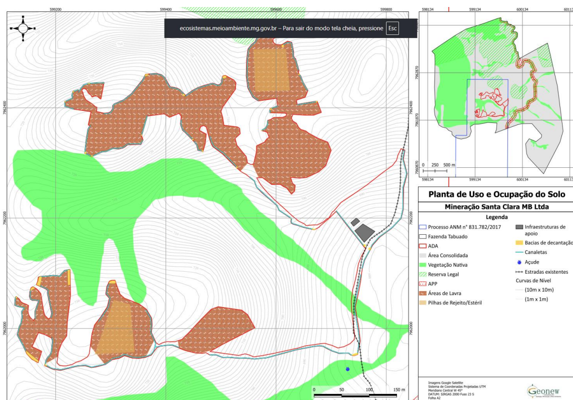
Figura 2 Layout do empreendimento com identificação do sistema de drenagem, infraestrutura, área de lava e pilha.
