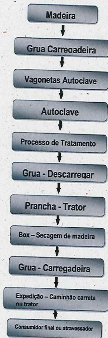
Figura 2. Fluxograma resumido do processo produtivo. Fonte: RADA
