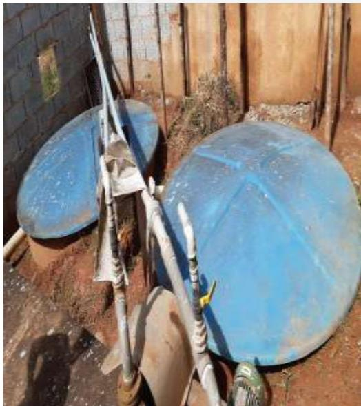
Foto 01: tanques sépticos e filtro anáerobico
