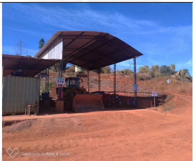
Foto 6: Oficina mecânica, com piso impermeabilizado e contenção de vazamentos
