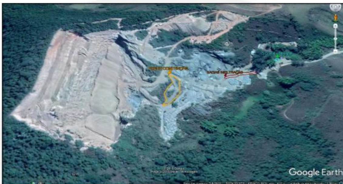
Figura 10: Sistema de drenagem pluvial constituído por dique de contenção, bacias de infiltração e dique filtrante. Fonte: RCA da Pedreira Oratórios.
