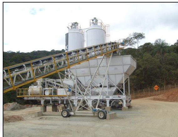
Foto 02. Dosadora de Agregados.
