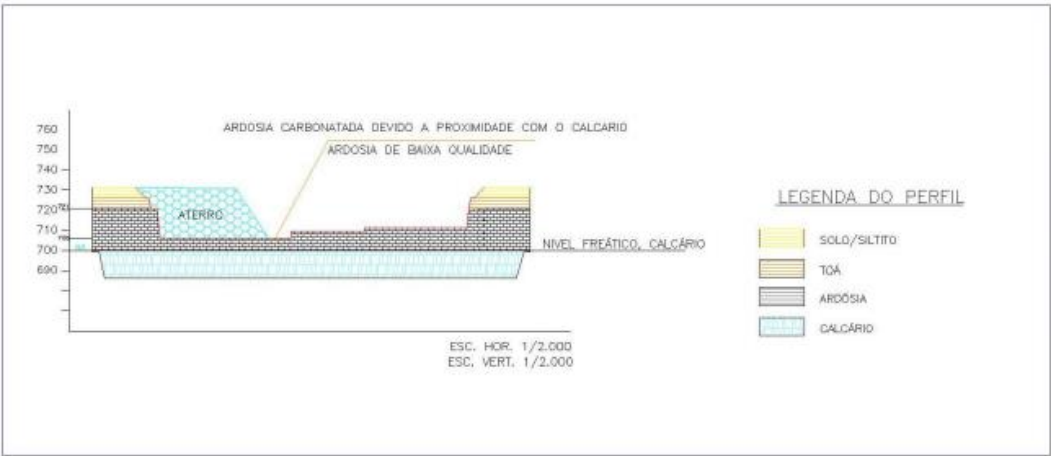
Imagem 08: Utilização de cava de mina para disposição de estéril ou de rejeito
