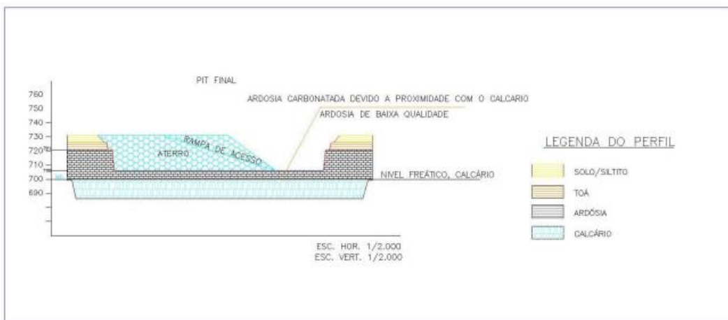
Imagem 10: Utilização de cava de mina para disposição de estéril ou de rejeito
