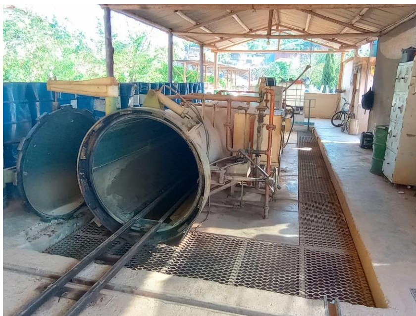
Figura 3. Autoclave e reservatório subterrâneo para contenção de vazamentos
