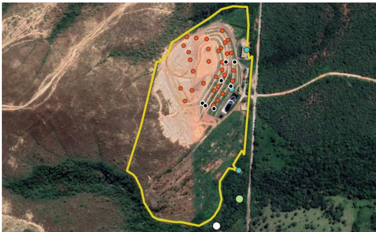
Imagem 03: Pontos de monitoramento geotécnico, águas subterrâneas e gás metano.
