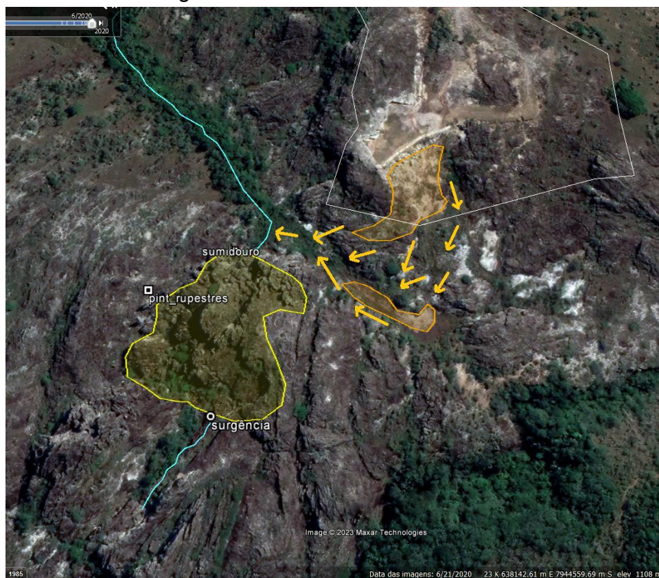
Figura 3: Depósitos lenticulares (polígonos alaranjados) de sedimentos mobilizados pela implantação da atividade minerária na ADA Leste. As setas amarelas indicam a direção dos fluxos de sedimentos, convergindo para o curso d’água que atravessa a caverna.
