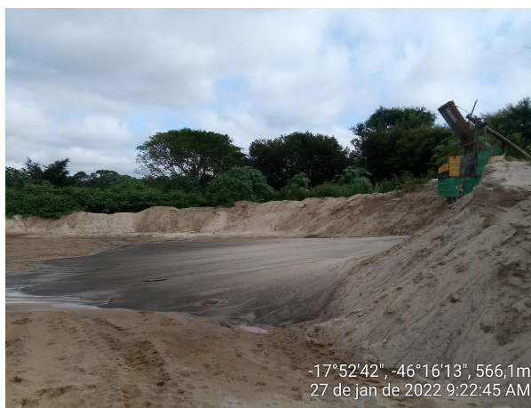
Foto 02. Porto de areia com sistema de classificação (peneiramento)
