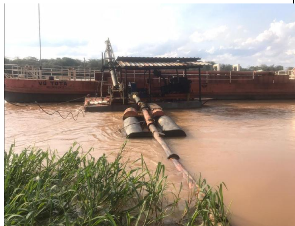
Figura 08: Dragagem e tubulação de transporte de polpa.
