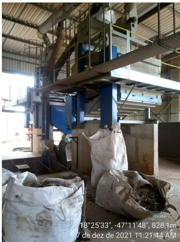
Foto 03. Equipamento de pré limpeza e bags de resíduos
